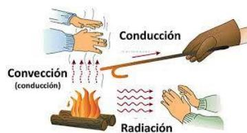
**1.- Conducción:** Es un proceso de transmisión de calor basado en el contacto directo entre los cuerpos o partes de un cuerpo, y tiene lugar sin intercambio de materia. Ocurre sólo en sólidos. Por ejemplo, al introducir una cuchara metálica en agua caliente, ésta comenzará a aumentar su temperatura debido a la energía recibida o si tocamos el extremo contrario de una barra metálica que se encuentra sometida a la llama de una vela.
